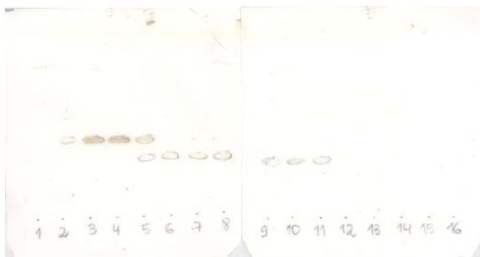
Esta separação foi realizada após recrystalização do esteviolbiosídeo. O resultado obtido demonstra a retirada dos residuais da hidrólise alcalina e aumenta o rendimento da separação. Tem-se os tubos 1 a 4 com frações de esteviolbiosídeo, o tubo 5 de transição e os tubos 6 a 11 com frações de rebaudiosídeo B.
